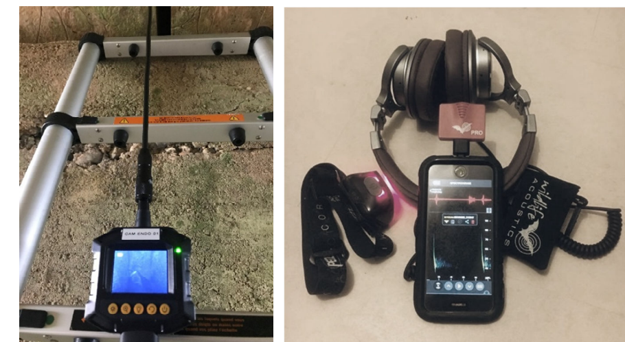
FIGURE 69 – CAMERA ENDOSCOPIQUE ET DETECTEUR ET ENREGISTREUR WILDLIFE ECHOMETER PRO, UTILISE POUR LES INSPECTIONS ET LES SORTIES DE GITES (SOURCE : ING ENVIRONNEMENT).
