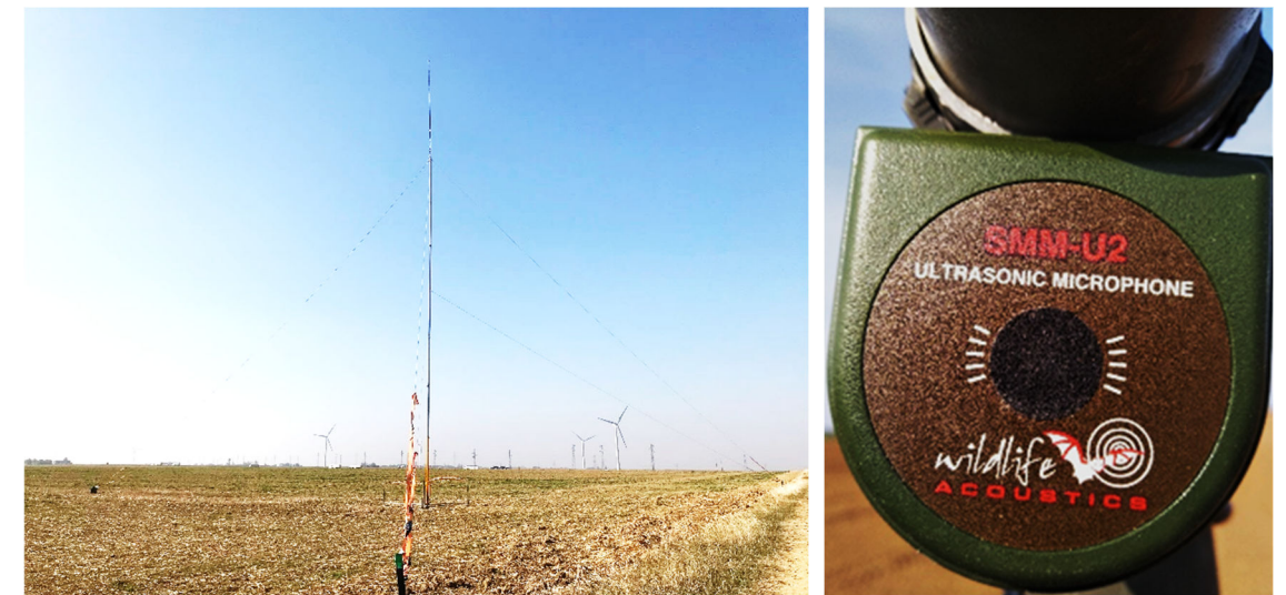
FIGURE 72 – MAT DE MESURES TELESCOPIQUE PNEUMATIQUE EN POSITION C3 SUR LE SITE DE TIVERNON, EQUIPE DE SM4BAT FS AVEC MICRO SMM-U2 EN TETE DE MAT ET AU SOL (SOURCE : ING ENVIRONNEMENT)
